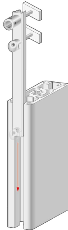
Gelenkhalter und Glasklemmen mit der Gewindeplatte M6 durch das Abdeckprofil vormontieren.
