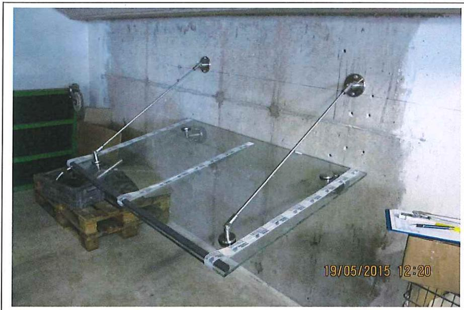
Bild 1 Versuchsaufbau der punktgelagerten Horizontalverglasung,
